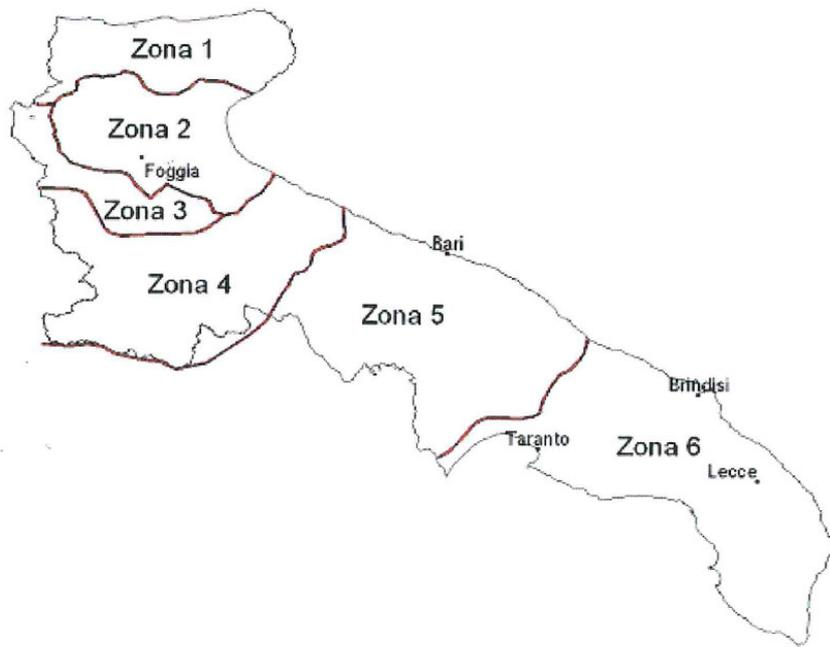
Figura 6.1.1 - Corografia della Puglia con delimitazione delle zone pluviometriche omogenee del VAPI
