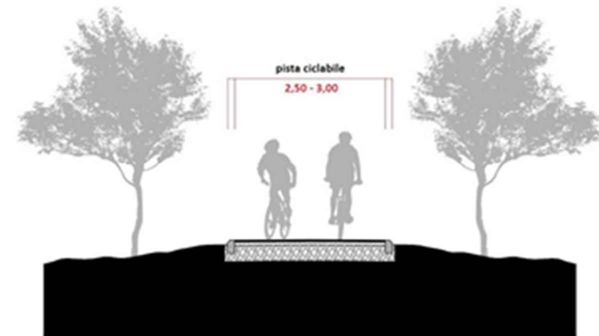
FIGURA 64 DETTAGLIO COSTRUTTIVO PISTA CICLABILE BIDIREZIONALE SEDE PROPRIA NON AFFIANCATA
