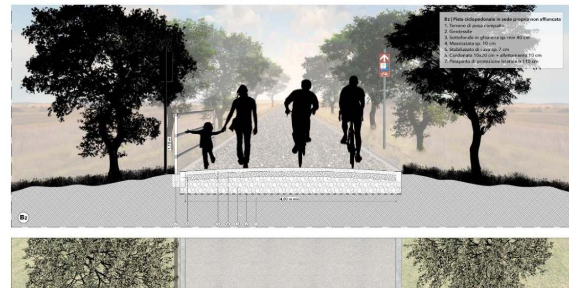
FIGURA 66 DETTAGLIO COSTRUTTIVO PISTA IN SEDE PROPRIA BIDIREZIONALE NON AFFIANCATA CICLOPEDONALE CON PAVIMENTAZIONE IN STABILIZZATO MISTO CAVA
